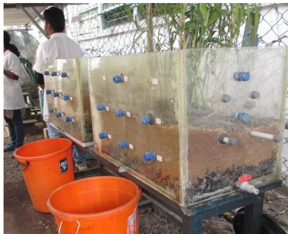
Photo : filtration d'eaux usées sur un projet de co-compostage, IIT Chennai
