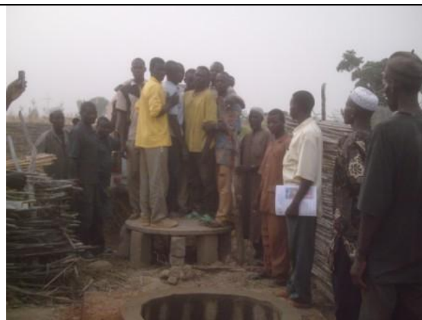
Test de solidité de la dalle SanPlat par les maçons formés
