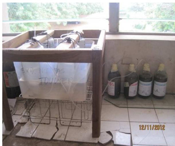
Figure 1 : Dispositif expérimental de la méthanisation des boues de vidange
