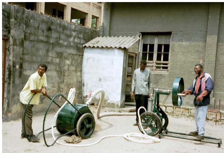
Figure 14: Petite cuve à boues reliée à une pompe manuelle d'aspiration à Mapet, Congo
