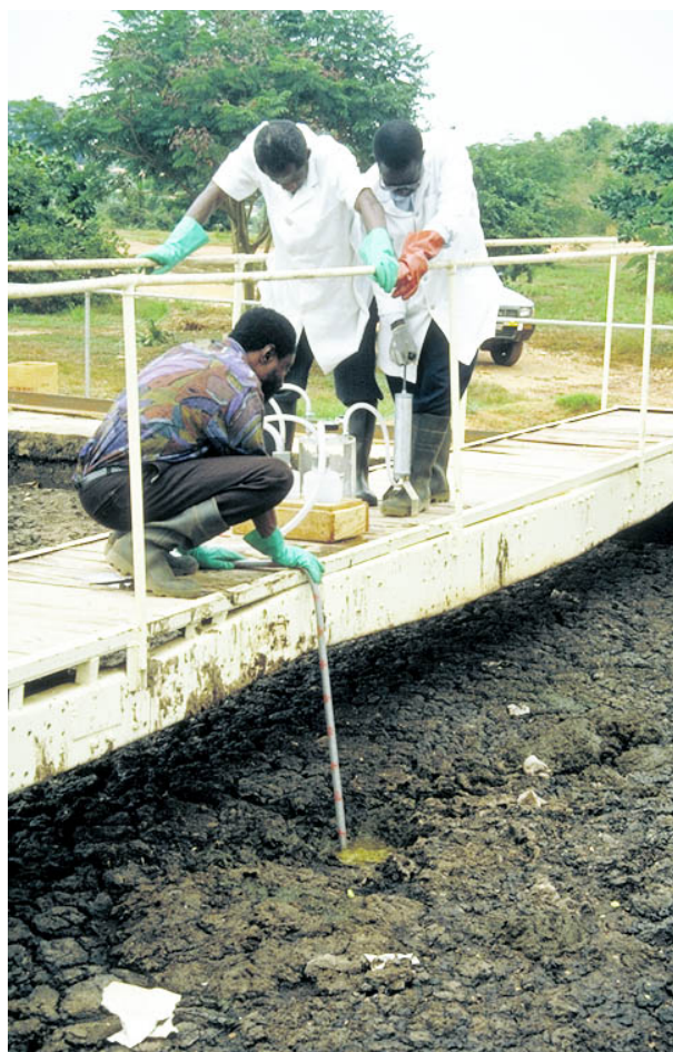
Figure 9: Tirer des enseignements d'installations existantes et de stations pilotes: Prélèvements dans un bassin de décantation à Accra, Ghana
