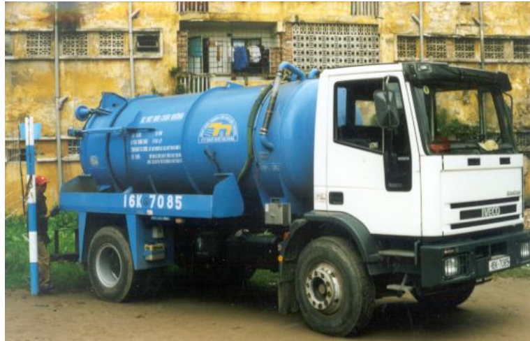
Figure 12: Camion-citerne de vidange par aspiration (7,5 m 3 ) à Hai Phong, Vietnam
