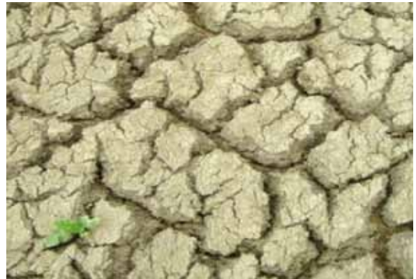
Figure 4 : Aspect de la boue au 33 ème jour de séchage (siccité atteinte : 54%)
