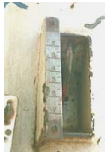
Photo 5 : Aiguille de remplissage d'un camion.
