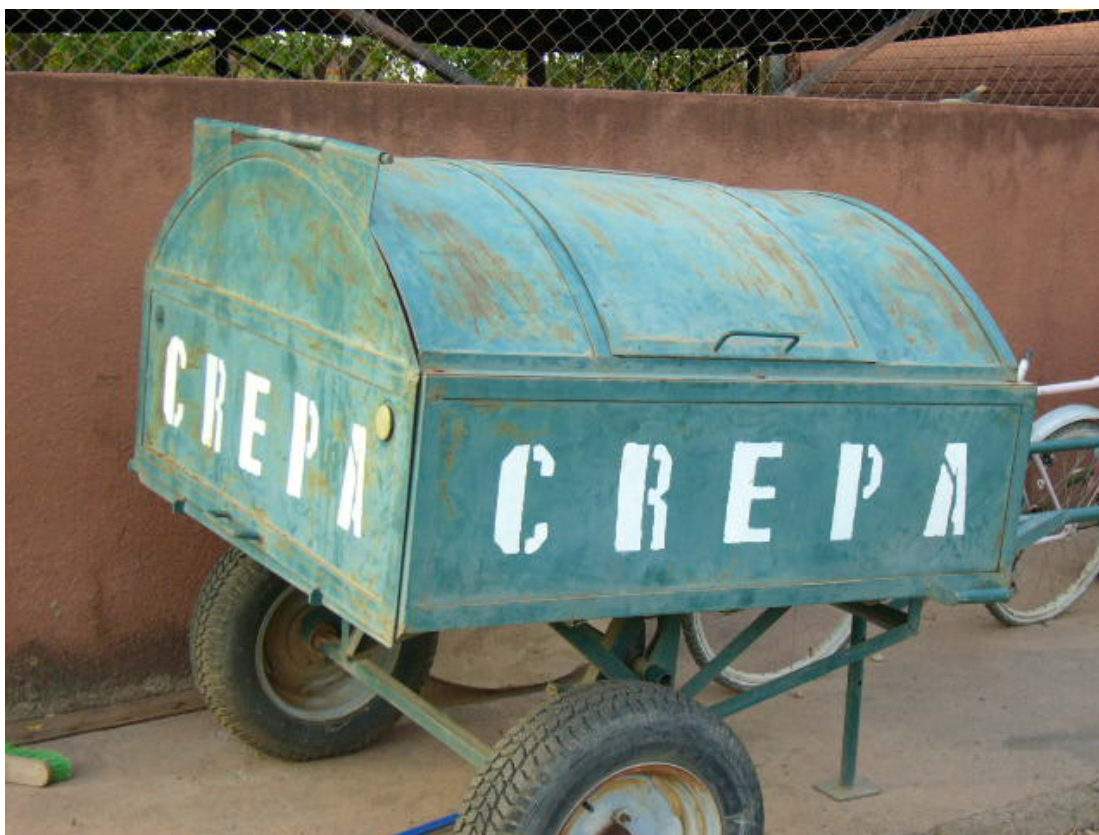
Charrette de type Tombereau Type CREPA utilisée pour la collecte des déchets solides, mais pourrait être adaptée pour le transport des boues vidangées manuellement.
