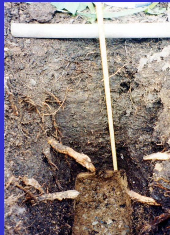
Biosolides accumulés avec racines et rhizomes de Typha
