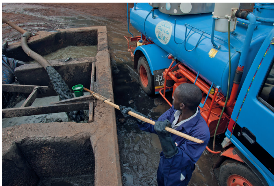
Figure 18.3 : Mise en œuvre de la méthode de caractérisation et de quantification des boues de vidange FAQ (Faecal Sludge Quantification and Characterisation) à Kampala, Ouganda (photo : Lars Schoebitz).
