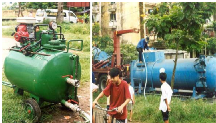
Figure 13: Mini-remorque de vidange par aspiration (350 l) utilisée pour les ruelles étroites et citerne de stockage transitoire placée dans l'artère accessible la plus proche à Hai Phong, Vietnam
