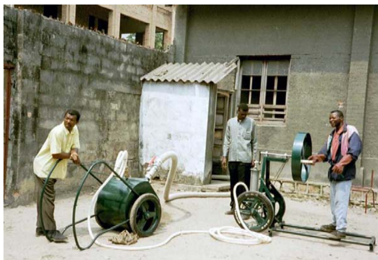
Figure 14: Petite cuve à boues reliée à une pompe manuelle d'aspiration à Mapet, Congo
