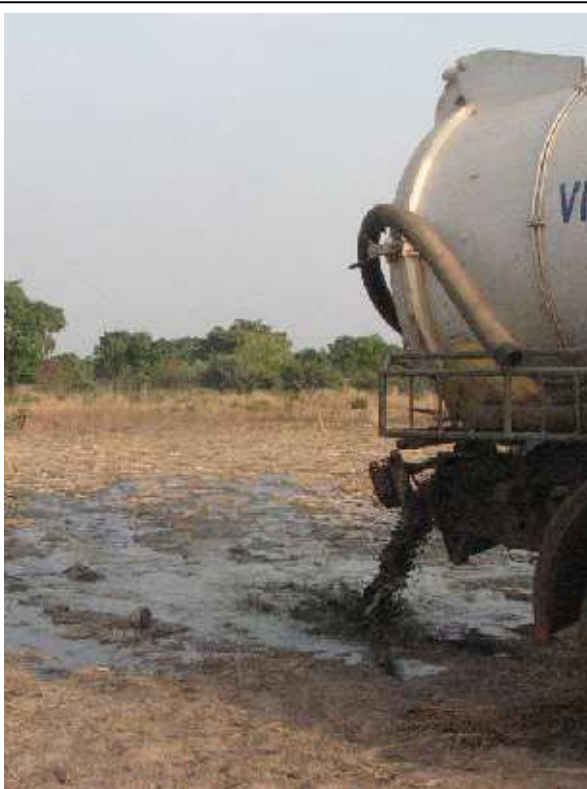
Photo 24 : Le déversement des boues de vidanges directement en brousse ou sur les champs peut être observé surtout de la vidange mécanique.
