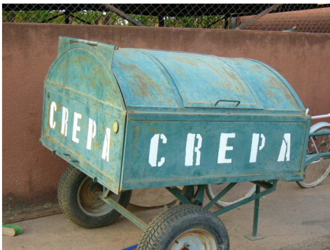
Charrette de type Tombereau Type CREPA utilisée pour la collecte des déchets solides, mais pourrait être adaptée pour le transport des boues vidangées manuellement.
